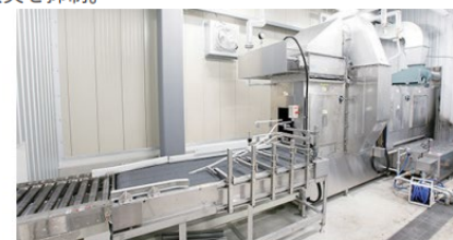
自社工場設備 自動制御のクレーンにより、フィルター洗浄・乾燥を自動化
